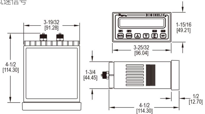
DH 系列 Digihelic® 差压控制器 是将数显差压表，差压开关和差压变送器组合在一起的三合一产品，将多个功能合为一体，可减少库存，节约安装的时间和成本。Digihelic® 差压控制器最适用于监控风压，风速和风量的应用场合，精度为 0.5%，量程范围从 0.25-100 in wc。
