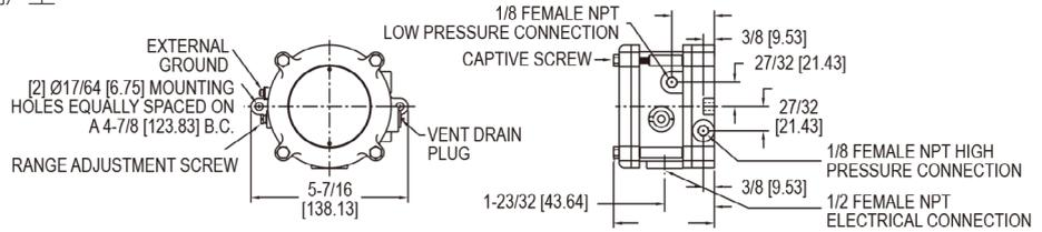
**1950 型防爆差压开关** 综合了 1900 系列差压开关的所有性能, 再配备防爆或全天候的防护外壳, 使其应用更加广泛, 应用价值也更高。它有 CE, UL, CSA, FM 认证, 级别为 Class I, Div 1, Groups C and D, Class II Groups E, F, and G and Class III hazardous atmospheres (NEMA 7 & 9), Raintight (NEMA 3)。全天候防护盖上带有排水堵头和 O 型环密封。很容易移除前盖来完成电路连接。防护壳体外部的设定点调节使用非常方便。提供 12 种型号从 .03 - 20 in.w.c. (0.0075 - 5 kPa) 还有从 .5 - 60 psi (0.035 - 3.5 bar)。它非常紧凑轻便 - 重量和体积相当于其它单独带防护的防爆开关的一半。
