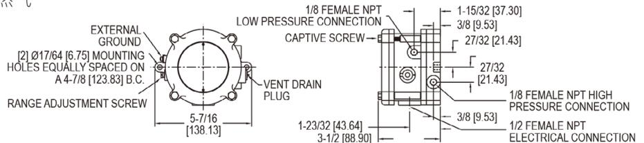
**1950G 系列防爆型微差压开关** 结合了常用的 Dwyer 1950 系列最好性能并且与天然气兼容, 可安装在室外并防水。开关通过 UL 认证, 可以在 UL 的 Class I 级 A, B, C, D; Class II 级中 E, F, G 中; Class III 级大气中使用, 2014/34/EU(ATEX) 适合于 ccc, Class II 2G Exd IIB & 氢气 T6 和通过 CSA & FM 认证的 Class I 级 Div. 1, B, C, D 组; Class II 级 Div. 1, E, F, G; Class III 级大气 IECEx Ex d IIB + H2 T6 (-40°C < Ta < +60°C)。1950G 体积小, 重量和体积相当于常规防爆开关的一半。
