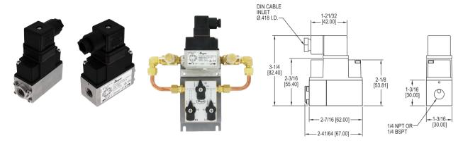
**629HLP 系列差压变送器** 适用于测量兼容气体和液体中的正压、负压或差压,精度为  $\pm$  1%。629HLP 适用于商业、工业应用场合或卫洁应用环境中的差压测量。压力传感器将压力的差别转换为标准的 4 - 20 mA 或 0 - 10 VDC 输出信号。
