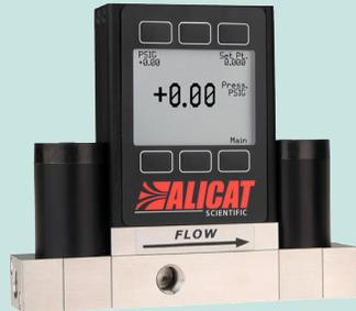
在密闭容器专用压力控制器中, 33 系列双阀压力控制器采用两个比例阀精确控制密闭或端开容器内气体压力。该系列产品可快速达到新的设定值并保持该设定值, 即使遇到不稳定的给进压力或者不断变化的温度, 亦如此。我们将利用您的应用参数为您定制阀门和 PID 调节功能, 确保您的控制器能实现快速、稳定的控制。
