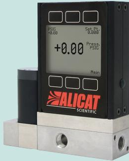
在流动过程介质专用压力控制器应用中，35 系列压力控制器（带远程取压）测量同一管路内任一点的绝压或表压，并控制另一个不同点的流量，确保系统压力保持在目标值。采用物理方式将压力传感器与阀门、流道相互隔离，这样，您可将压力准确控制在您需要的值。因此，您可对难以安装整套压力控制器的区域进行压力控制，这将减少大流量应用中因流量导致压力变化而产生的影响。我们将根据您的应用参数为您定制阀门和 PID 调节功能，确保您的控制器能实现快速、稳定的控制。
