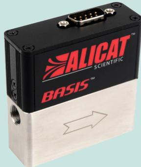
美国 ALICAT 01 系列质量流量控制器, 采用了热贴片式原理, 而且克服了热式对于预热时间的要求, 01 系列的预热时间仅需要 70 ms, 且保证了流量控制的稳定性和精确度。测量和控制范围高达 0.5 ~ 100% 满量程, 可以满足更多的客户流量控制应用场合。
