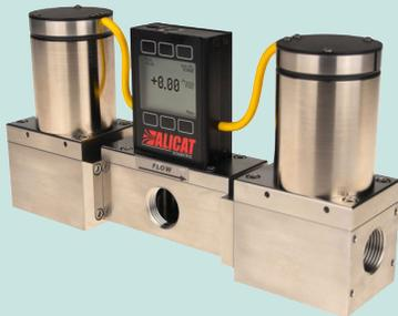
在密闭容器专用压力控制器中，34 系列双阀压力控制器采用两个比例阀精确控制密闭或端闭容器内气体压力。该系列产品可快速达到新的设定值并保持该设定值，即使遇到不稳定的给进压力或者不断变化的温度，亦如此。我们将利用您的应用参数为您定制阀门和 PID 调节功能，确保您的控制器能实现快速、稳定的控制。
