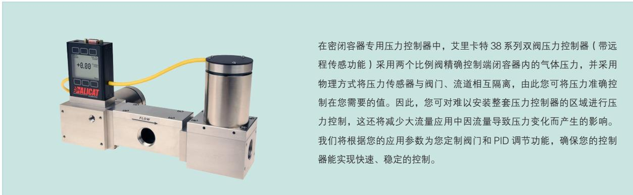
在密闭容器专用压力控制器中，艾里卡特 38 系列双阀压力控制器（带远程传感功能）采用两个比例阀精确控制端密闭容器内的气体压力，并采用物理方式将压力传感器与阀门、流道相互隔离，由此您可将压力准确控制在您需要的值。因此，您可对难以安装整套压力控制器的区域进行压力控制，这还将减少大流量应用中因流量导致压力变化而产生的影响。我们将根据您的应用参数为您定制阀门和 PID 调节功能，确保您的控制器能实现快速、稳定的控制。
